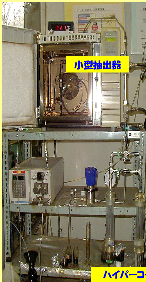
小型流通式ハイパーコール製造装置 (0.1-1.0 g/run: 産総研)
