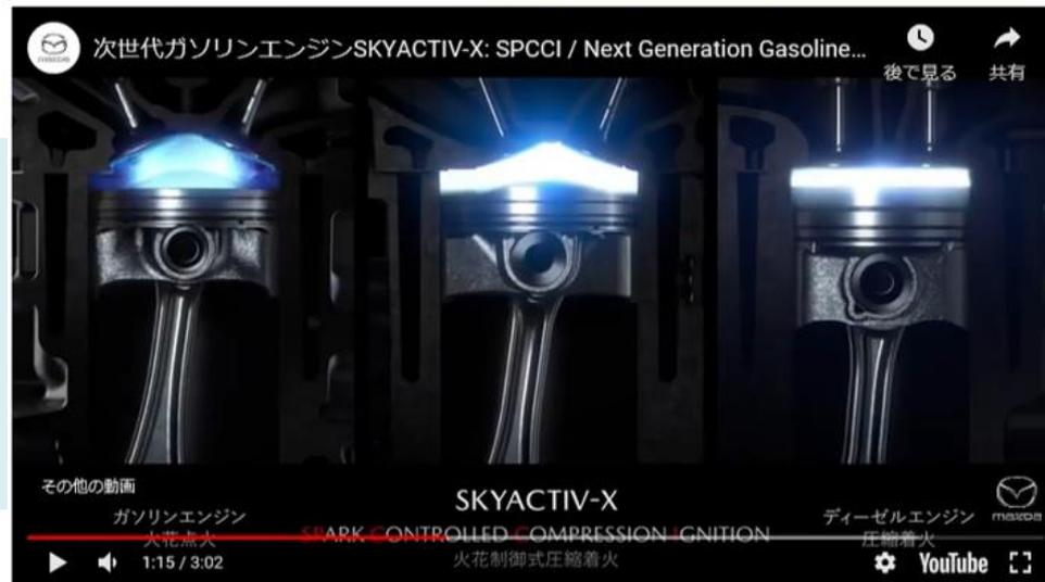
ディーゼルエンジンの圧縮着火では使用しないスパークプラグの活用や、燃焼範囲の拡大などにより、ガソリンエンジンの燃費を20~30%向上、CO2排出量を20~30%削減。
